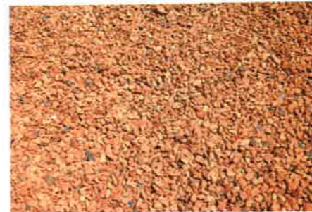
瓦チップは透水性が高く、水たまりがでにくい。ヒートアイランド現象を抑制する効果も期待できる
