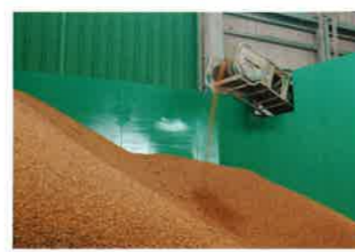
瓦を粉砕してチップ状に加工。屋内プラントなので周辺への影響もほぼない
